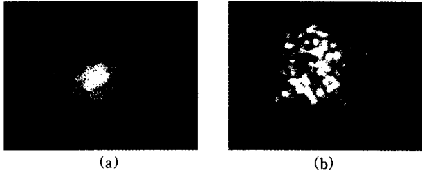
그림 4. 광섬유에서 회절되는 스펙클 패턴 (a) 단일모드 광섬유 (b) 다중모드 광섬유
