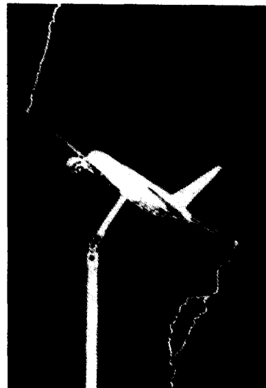
그림 1. 777스케일 모델을 사용한 점보여객기의 電被害시험 (寫眞은 The Boeing Company 자료)
