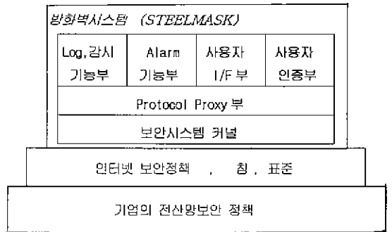
(그림 2) POSCO의 방화벽시스템 기능구성도
