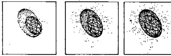
(그림 2) 팽창 및 수축을 갖는 곡면 (Fig. 2) An active surface with partial inflation and deflation
