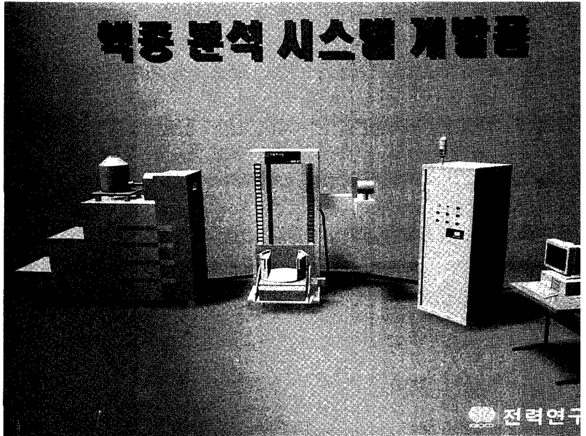
국내에서 개발한 드럼 회전형 핵종 분석을 위한 콜리메이터 구동 및 제어 장치
