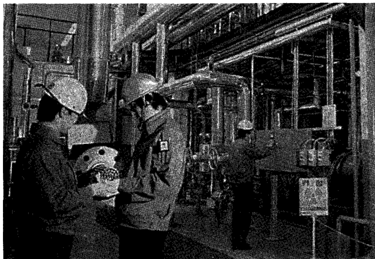
원자로와 같은 온도·압력으로 핵연료 등의 구조와 재질을 시험할 수 있는 Hot Test Loop 시설
