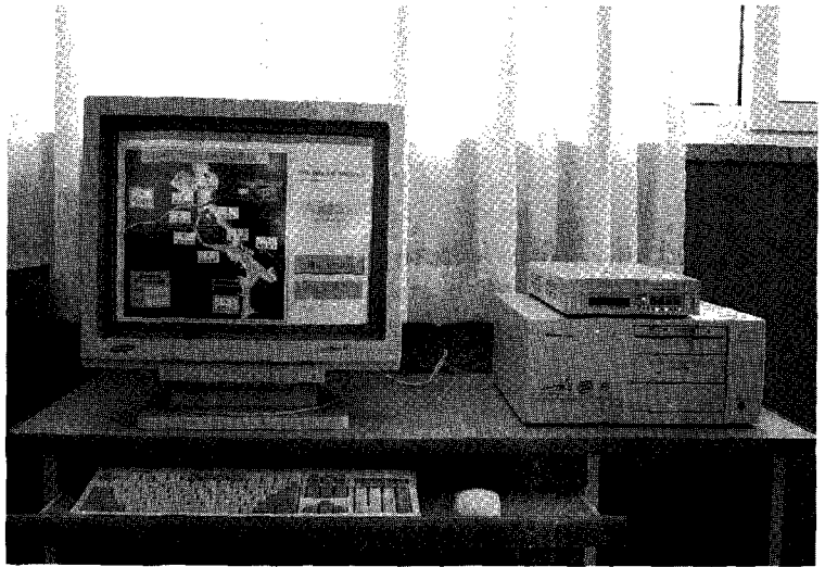
원전 주변의 환경 방사선을 연속적으로 감시할 수 있는 환경 방사선 감시 단말기. 원전 소재 근청에 설치되어 있다.
