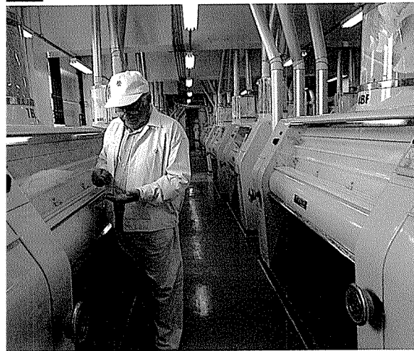
▲ 정선과 가수과정을 거친 원맥은 분쇄공정을 거쳐게 된다. 삼양사는 이 과정에서 많은 영양소가 파괴된다는 것을 감안, 비타민과 철분을 추가로 투입한 영양강화 밀가루를 개발했다.
