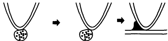
Glue bulb가 공기저항으로 뒷쪽으로 밀린 현상과 그에 따른 한쪽만의 Shoulder접착
