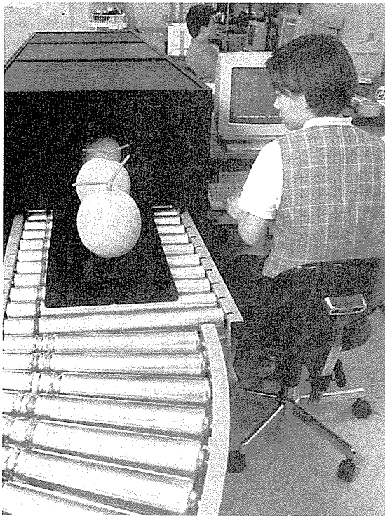
▲ 이동형 레이저 당도 계측장치를 이용하여 두꺼운 껍질을 가진 과일의 당도를 측정하고 있다.
