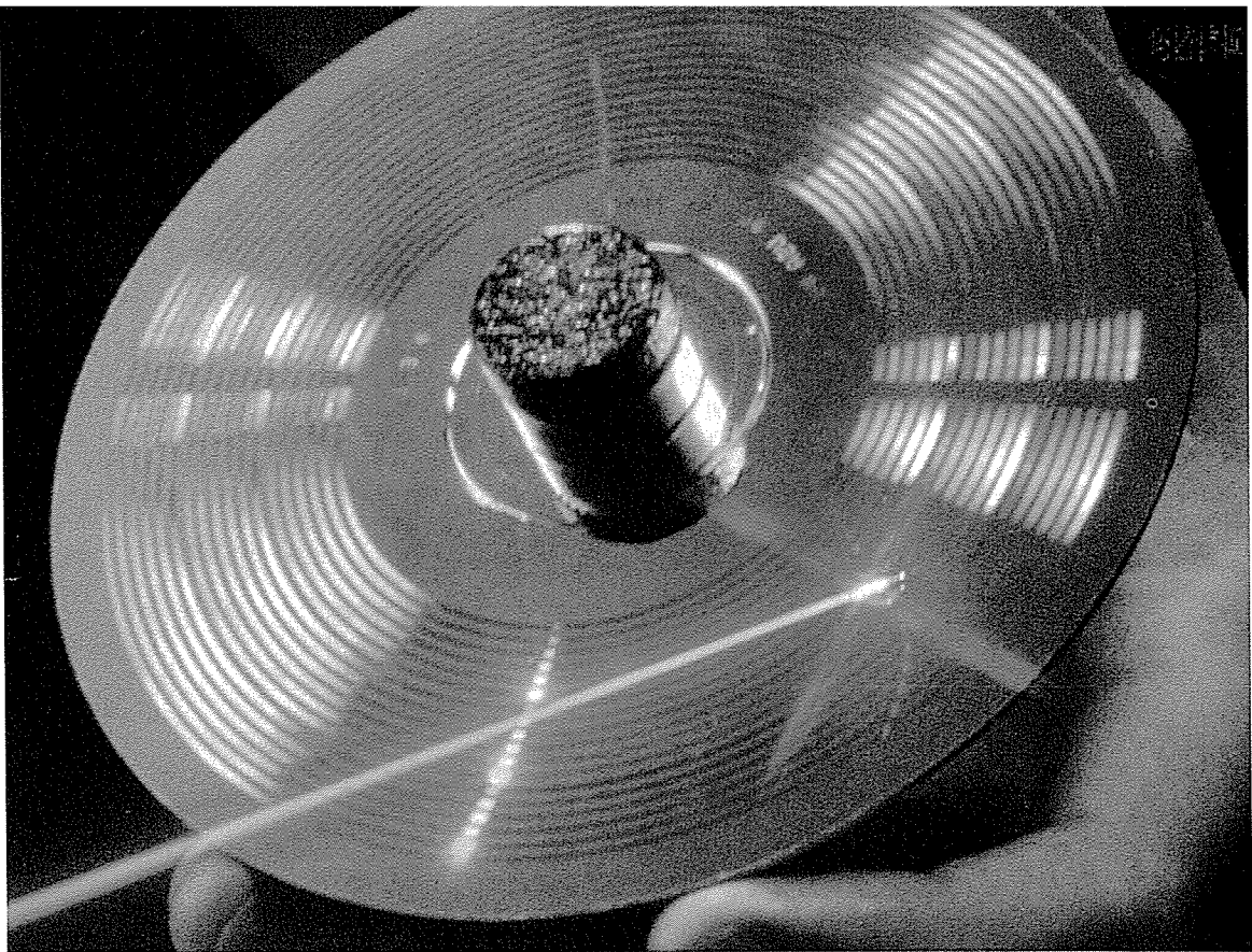
▲ 청색 레이저가 실용화되면 DVD 한면에 12기가바이트의 정보까지 수용할 수 있다. 사진에서는 비선형 광결정이 적외선 레이저의 파장을 전환하여 청색 레이저를 만들고 있다.
