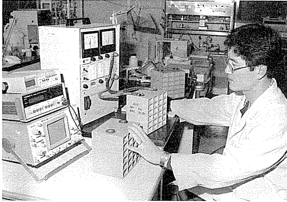
▲ 개발된 Super-capacitor(초고용량 축전지)의 충·방전 실험장면
