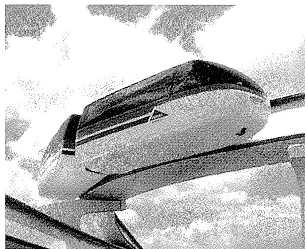
기존의 도시 교통 시스템에 비해서 건설비용이 적게 드는 새로운 시스템이 미국에서 개발됐다. 사우스 캐롤라이나주 찰스턴에 있는 퍼렉스사가 개발한 ‘모노빔’이라 불리는 이 도시 수송 시스템은 개념에 있어서는 모노레일과 비슷하지만 모노레일에서는 양 방향의 전차가 두개의 분리된 철로 위를 달리지만 모노빔은 삼각형으로 이루어진 범의 양쪽에 전차가 매달리게 된다.
