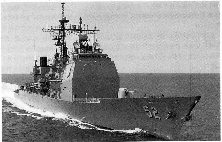
최초로 Mk41 VLS 시스템이 장착된 Ticonderoga급 이지스함 Bunker Hill(CG-52)
