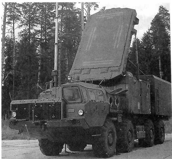
S-330PMU-1의 중심이 되는 다기능 교전 레이더 ▶ 가운데에 레이더장비밴과 그위에 위상배열안테나가 운용상태로 올려져 있고 맨 뒤에는 포대 지휘소 밴이 보인다
