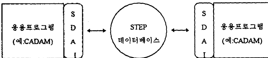
<그림 7> 기존 CAD 시스템간에 SDAI 를 이용한 구조
