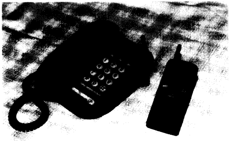
대우통신 900MHz 유무선 전화기 '아망떼 크린 900' (모델명 : DV-5094) 휴대폰처럼 간편한 플립형 휴대장치를 채택하고 통화가능 거리를 벗어나면 경고음이 울려 통화가능 여부를 쉽게 알 수 있다.
