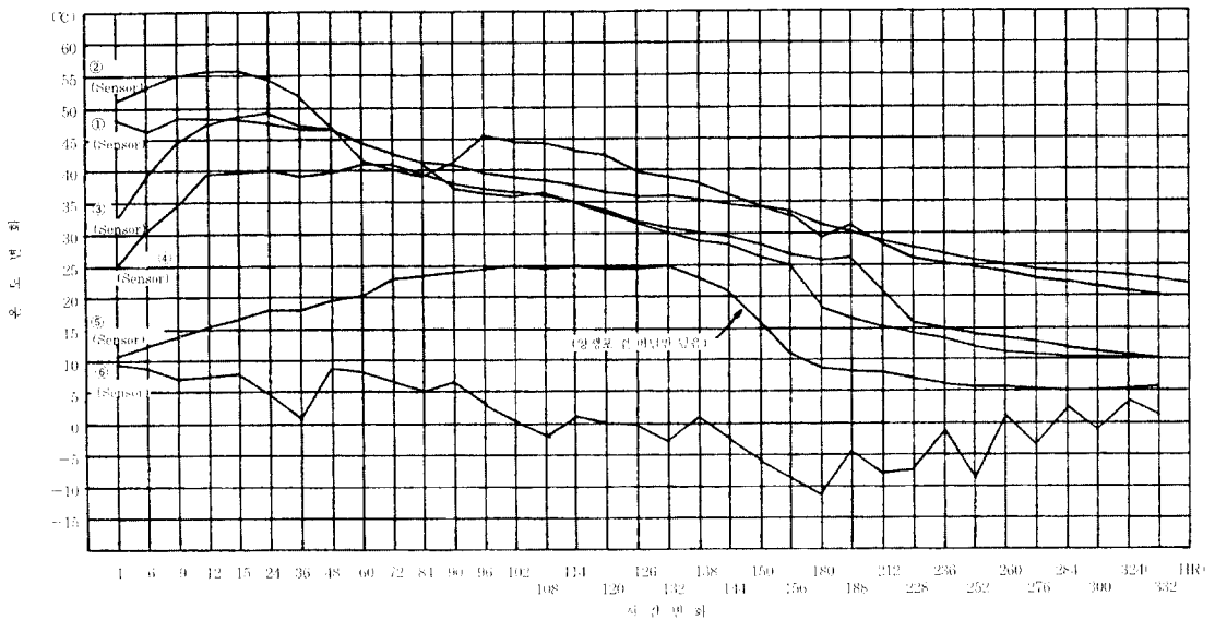
그림 9 시간변화에 따른 콘크리트 평균 수화열
