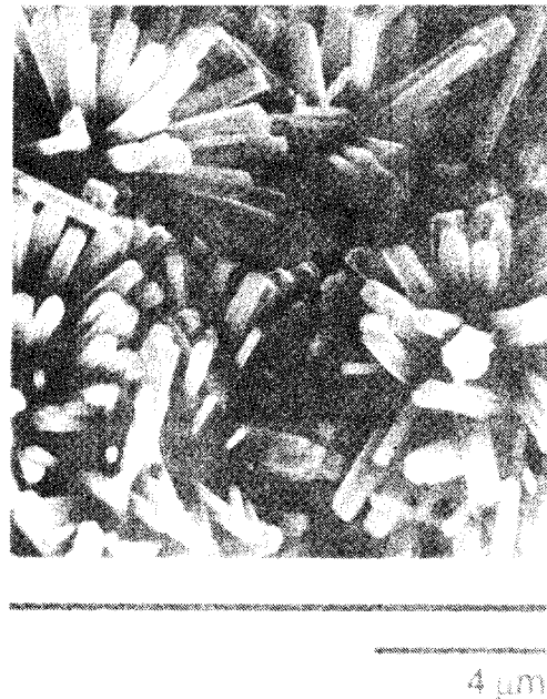
그림 3. 액상침전법으로 제조한 ZnO의 미세구조. Fig. 3. SEM micrograph of aqueous precipitated ZnO.
