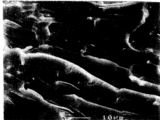
사진 5. 에폭시 수지 100[phr]/MA 수지 35[phr] 시편의 전자현미경 사진
