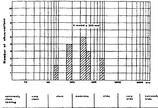
그림 8. 절리의 최소, 평균, 최대 간격 S_{min} , S , S_{max} 을 보여주는 histogram.
