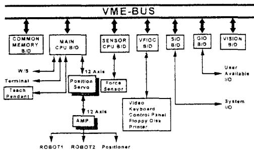
그림 5. 다중 로봇 제어 시스템의 하드웨어 구조
