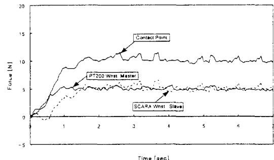
그림 7. 마스터/슬레이브 제어 구조를 갖는 이중 로봇의 힘 응답
