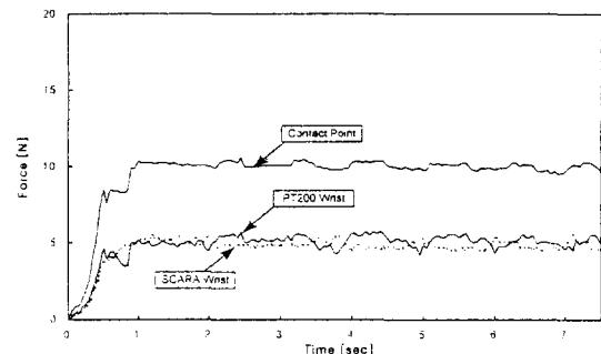
그림 8. 단일화된 컴플라이언스 제어 구조를 갖는 이중 로봇의 힘 응답
