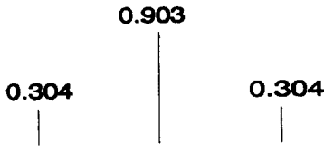
그림 11. 채널 II 의 임펄스 응답 Fig. 11. Impulse response of channel II.
