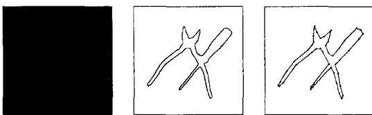
(a) 입력영상 (b) 경계선 추출 (c) 다각형 근사화 그림 6. 입력영상에 대한 다각형 근사화의 결과 Fig. 6. Polygon approximation of input image.
