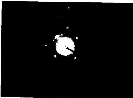
그림 2. 실리콘 기판위에 전자빔 증착방법에 의하여 상온에서 4nm의 코발트를 증착한 실리콘/코발트 계면의 전자회절패턴
