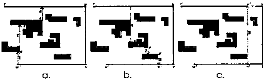
(그림 6) 줄일 수 있는 우회 없애기 (r \rightarrow u \rightarrow v \rightarrow u' \text{ 를 } r \rightarrow u' \rightarrow v' \rightarrow u' \text{ 로}) (Fig. 6) Deleting the Reducible Detour (r \rightarrow u \rightarrow v \rightarrow u' \text{ to } r \rightarrow u' \rightarrow v' \rightarrow u')
