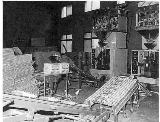
이러한 보리쌀 소비확대에 걸림돌이 되는 요소를 개선하여 상품화시킨 것이 바로 “할맥”이다. 할맥의 생산에는 20단계의 공정이 소요되는데, 보리원료를 정선(먼지, 돌 등 이물질 제거)하여 1차 선별가공후, 원료를 조절(Tempering)한 다음 종구를 따라 절단 분리하게 된다. 이 과정에서 종구부분을 제거하고 다시 2차 연삭식 가공을 거쳐 크기와 입도를 쌀과 같이 작고 고르게 선별한다. '86년 까지 할맥은 이 공정까지로 제품(건강보리쌀)을 생산하였으나, 현재는 이것을 다시 증자(Boiling),
