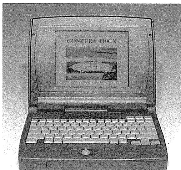
컴팩의 보급형 노트북 모델인 컨츄라 400시리즈 중 410CX는 486DX2/ 50MHz CPU와 350MB의 하드디스크를 장착하였으며, LCD에 따라 9.5인치 듀얼스캔 STN을 8.4인치 TFT 컬러를 채용한 컨츄라 410C와 8.4인치 TFT 컬러 LCD를 채용한 410CX로 나뉘어진다.
