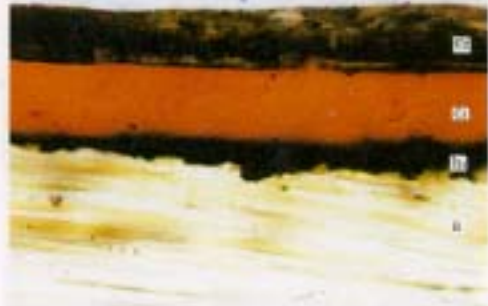
Photo 14. 杖4 漆塗膜構造
