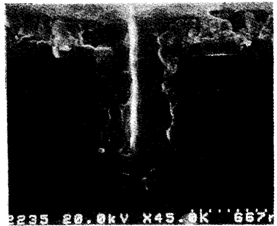
(그림 5) Contact Size 0.6\mu\text{m} , A/R 1.8인 Contact Hole에 PVD Ti 400Å\CVD TiN 600Å\RTA\PVD Ti 1000Å을 증착한 다음 Al Planarization을 적용한 Wafer의 단면 SEM 사진
