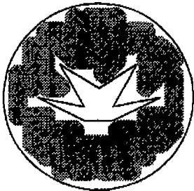
Fig. 18 복잡한 윤곽을 갖고 있는 아일랜드에서의 공구경로 ( \alpha = 0.2, w = 1 )
