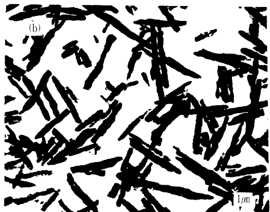
그림 2. 비디오테이프의 전형적인 구조와 자성체 입자의 투과전자현미경 사진
