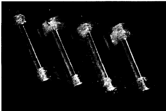
사진 1. 제작된 트랜스듀서의 사진 Photo. 1. Photograph of fabricated transducers.
