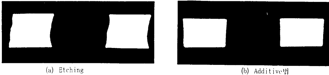
그림 2. Stencil Opening 벽면의 단면 모양
