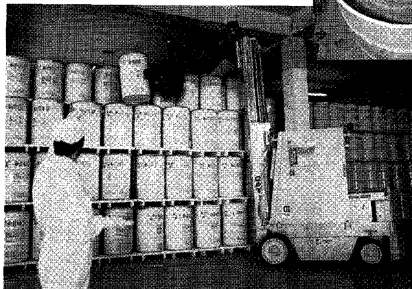
原電 부지내의 저준위 폐기를 임시저장고
