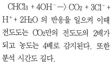
막을 이용한 전도도 측정법은  $\text{CO}_2$  만을 선택적으로 통과시키는 homogeneous teflon membrane을 이용하여  $\text{CO}_2$ 만을 선택적으로 걷지하여
