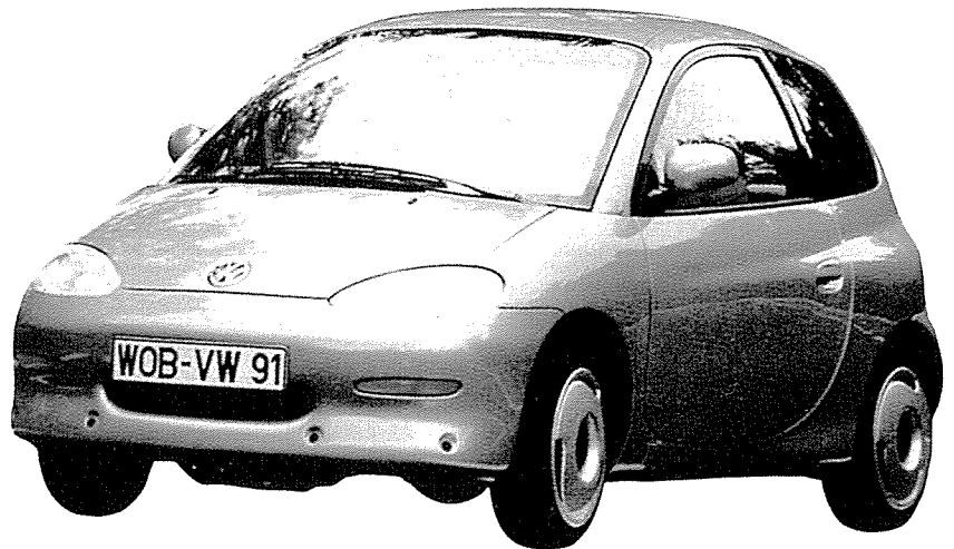
◇1995년 양산에 들어가는 폴크스바겐사의 가솔린-전기 혼성형차는 주로 시내에서는 니켈-카드뮴 배터리로 주행하고 가솔린엔진은 56km 이상의 속도를 낼 때 사용한다.
