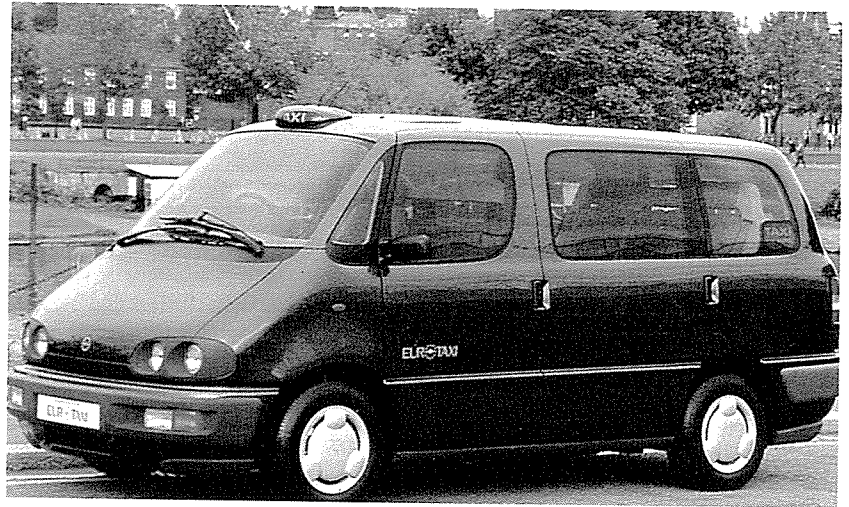
◇ 시내주행용 유럽택시는 나트륨 황 배터리로 한번 충전에 1백60km를 주행할 수 있다. 시계를 벗어나면 디젤발전기로 발전하여 배터리를 충전한다.
