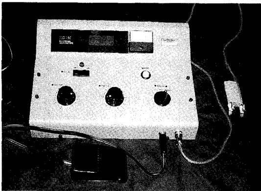
그림 1. 건국대 생물학과에서 개발한 고전압 직류발생기. 전압과 주파수를 조절할 수 있는 다이얼과 전원을 단속할 수 있는 발판이 있으며 양극과 음극의 단자가 있다.
