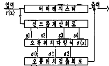
그림 8. 복호기의 블록 다이어그램 Fig 8. Block diagram of decoder
