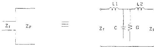
그림 4. 패치의 가장자리 효과를 고려한 마이크로스트립 연속의 등가회로
