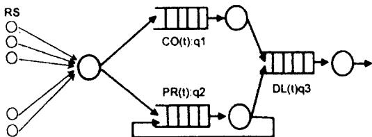
그림 7. 제안된 방식을 이용한 시스템의 각 단계별 큐잉 모델
