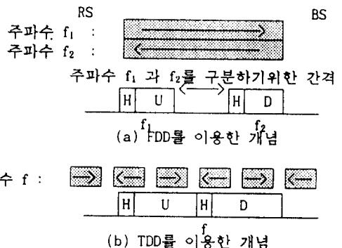
그림 2. FDD와 TDD를 이용한 주파수 개념
