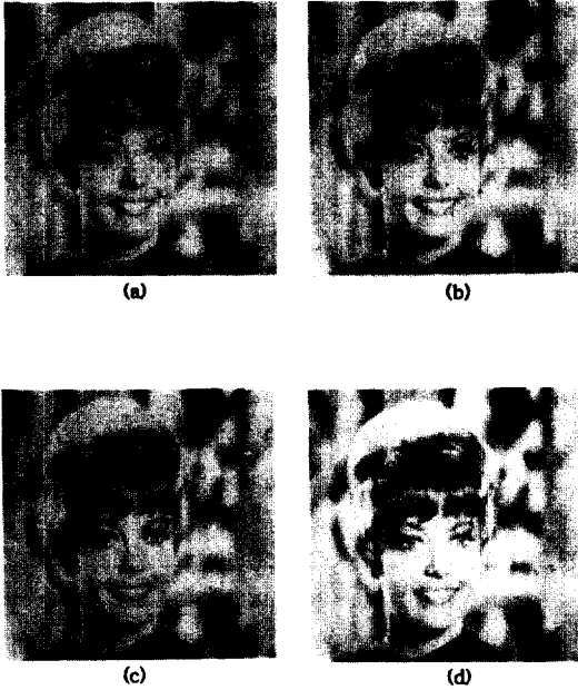
그림 6. 기존의 VQ와 2채널 VQ에 의한 재생 영상 (a) 기존의 VQ (b) 2채널 VQ (c) 기존의 LOT/VQ (d) 2채널 LOT/VQ Fig. 6. Reconstructed image by conventional VQ and 2channel VQ (a) conventional VQ (b) twochannel VQ (c) conventional LOT/VQ (d) twochannel LOT/VQ
