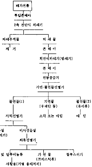
그림 6. 처리공정 2(폐가전제품만 처리하되 유가부품을 미리 제거하고 처리)
