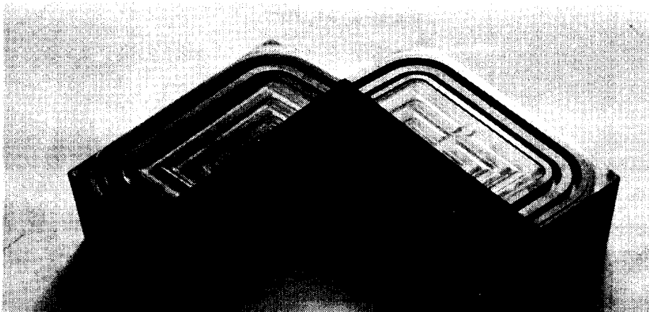
Fig. 6 Separated upper die
