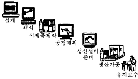
그림 1 단계적으로 이루어지는 기존의 제품 설계 제작 과정
