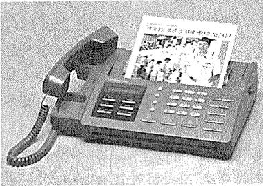
이 제품에 내장되어 있는 TIP은 1초에 1,200만개의 명령어를 동시에 처리하는 최첨단 반도체인 DSP(Digital Signal Process)로서 세계 최초로 상대방측에서 표준모드로 원고를 송신할 경우에도 화질을 개선시켜 선명한 원고를 받을 수 있는 기능과 인간이 시각적으로 느끼는 밝기와 동등하게 하여 화질을 개선하여 살아있는 듯한 선명한 화질을 보낸다.
