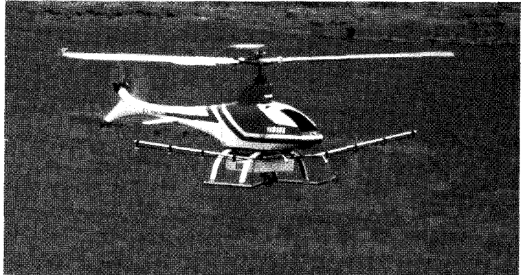
사진1. 약제살포장치를 탑재한 무인헬기 R-50(논에서의 작업광경)
