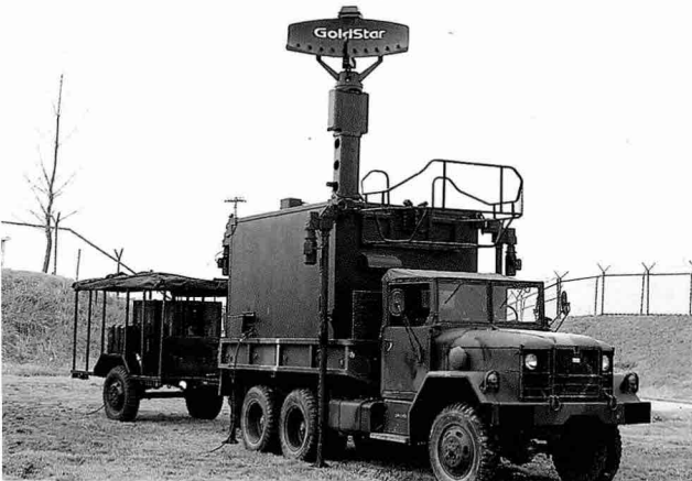
금성정밀이 해외수출에 나서는 대표적 장비 위 사진은 주파수 도약형 차기 FM 무전기 아래 사진은 GLAS-830M 저고도 탐지레이더다
