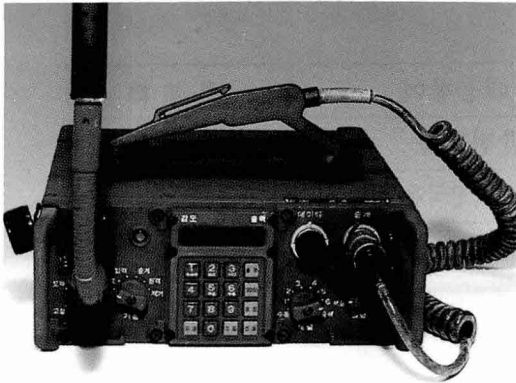
금성정밀이 해외수출에 나서는 대표적 장비 위 사진은 주파수 도약형 차기 FM 무전기 아래 사진은 GLAS-830M 저고도 탐지레이더다
