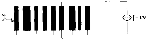
그림 3. 단일 탭 변환기 Fig. 3. Single tap trasducer.
