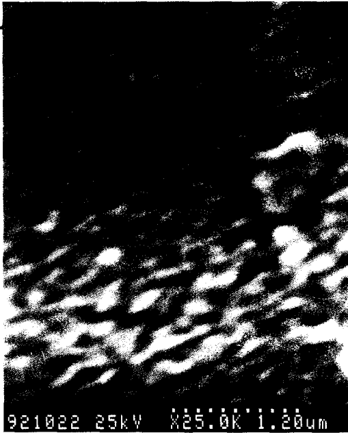
그림 6. 고상결정화시킨 시편의 SEM 사진 Fig. 6. SEM micrograph after of the SPC annealing.
